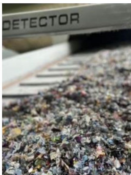
Photo 11 : Le matériau homogénéisé après le broyage.
