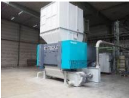
Photo 2 : Le nouveau VIZ de Vecoplan : flexible, nécessitant peu d'entretien et économe en énergie.
