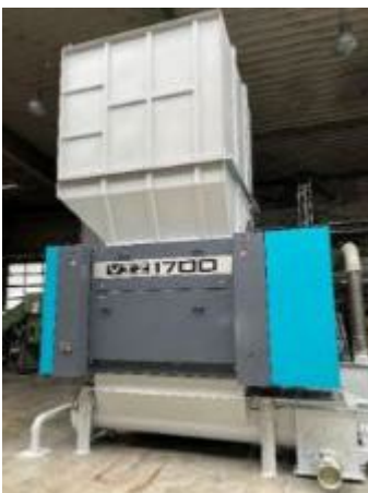
Photo 5 : La vis sans fin, également fournie par Vecoplan, achemine le matériau broyé à un ventilateur d'aspiration qui le transporte vers un silo de stockage.
