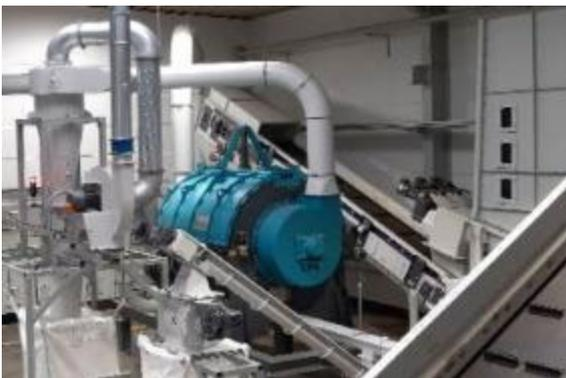
**Bild 2:** Bei der Trockentechnologie werden Verunreinigungen wie Papierfasern, Staub oder organische Rückstände mechanisch entfernt. Durch den rotierenden Rotor treten gelöste Verschmutzungen aus, während Fasern und Schmutz zuverlässig absaugt werden.
