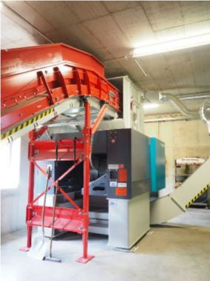
Photo 3 : les dossiers atterrissent dans le broyeur de Vecoplan après avoir été acheminés sur la bande transporteuse (rouge) du client.
