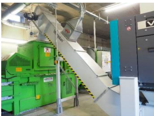
Photo 6 : Vecoplan a livré, de plus, un convoyeur à racloirs qui transporte le matériau déchiqueté jusqu'à la presse.
