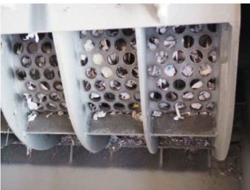
Photo 9 : selon le degré de sécurité exigé, les tailles de grille nécessaires se remplacent facilement et en quelques minutes seulement.
