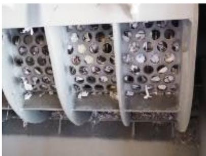
**Bild 9:** Je nach geforderter Sicherheitsstufe lassen sich die erforderlichen Siebgrößen innerhalb weniger Minuten leicht austauschen.
