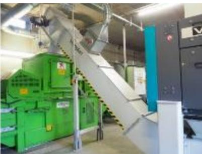
**Bild 6:** Vecoplan lieferte zudem einen Kratzkettenförderer, der das geschredderte Material in die Presse transportiert.
