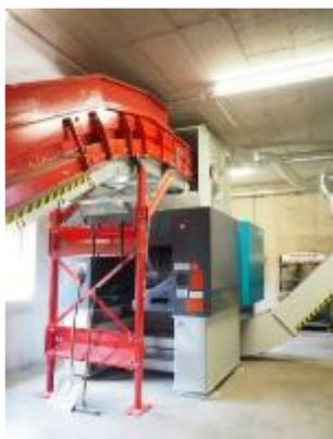
**Bild 3:** Über das kundenseitige Förderband (rot) gelangen die Akten in den Vecoplan Zerkleinerer.
