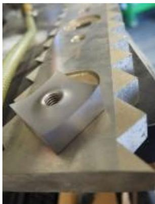
**Bild 7:** Eine Schneidkrone auf einem Gegenmesser – beides lässt sich einfach tauschen und mehrfach verwenden.
