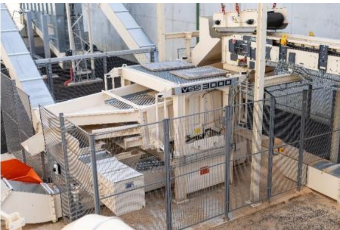
Bild 5: Mit dem Schwingsichter kann Lesbats das Material effektiv sieben und erhält so die gewünschte Fraktionsgröße.
