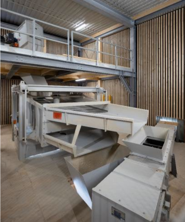
Photo 4 : l'installation de criblage intelligente avec crible oscillant VSS 6000 assure un criblage efficace de la matière déchetée.
