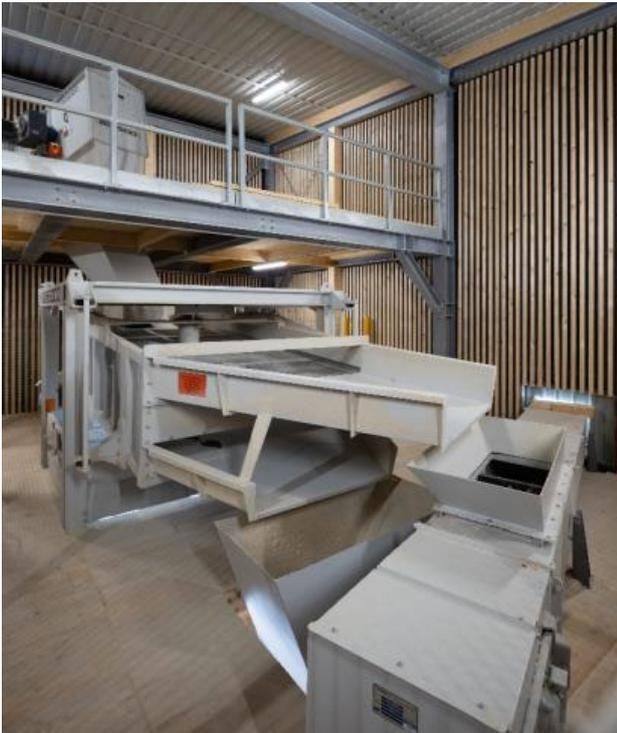
**Bild 4:** Die intelligente Siebanlage mit Schwingsichter VSS 6000 sorgt für eine effektive Siebung des Hackguts.
