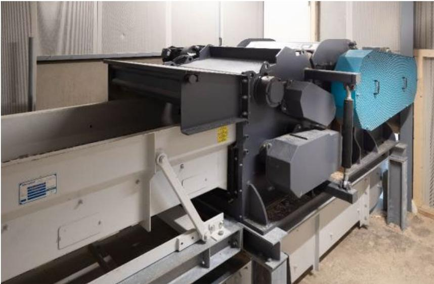
**Bild 2:** Der Vecoplan Hacker VTH 250-850 produziert hochwertiges Hackgut für die spätere Weiterverarbeitung.
