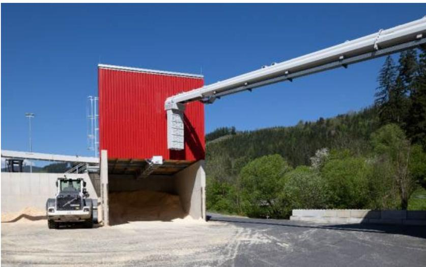
**Bild 5:** Das feine Hackgut gelangt über das Rohrgurtfördersystem VRF 500 P zu dem Schwingsichter VSS 6000 über den Späneboxen.
