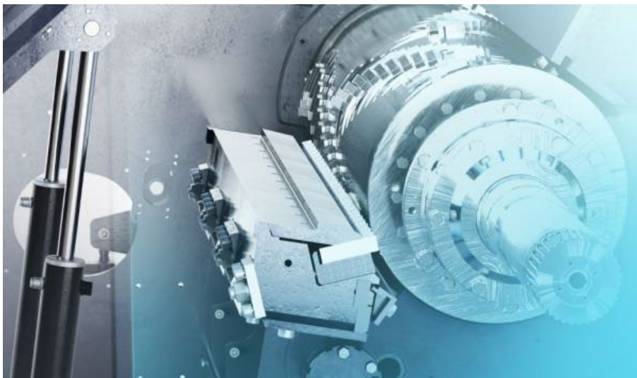
Photo 2 : Précision intelligente : le réglage automatique du contre-couteau garantit une qualité de broyage élevée et constante
