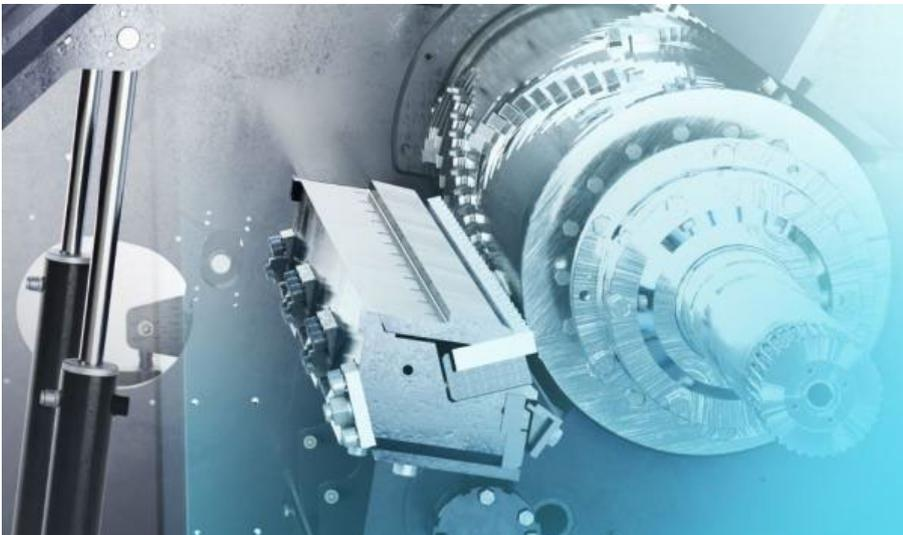
**Bild 2:** Smarte Präzision: Die automatische Gegenmesserverstellung gewährleistet eine konstant hohe Zerkleinerungsqualität
