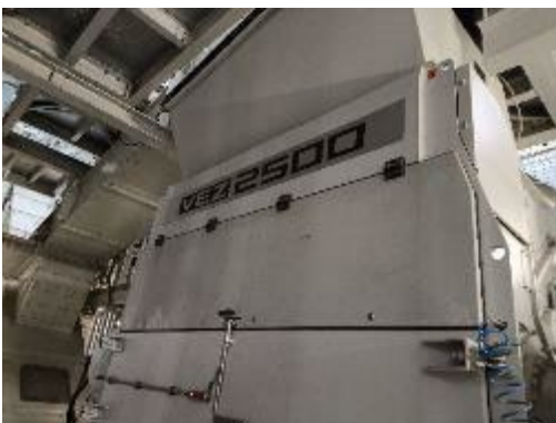
Bild 9: Für die Nachzerkleinerung setzt die MBS-Anlage auf den VEZ 2500, der speziell für die Herstellung von Ersatzbrennstoffen konzipiert wurde.
