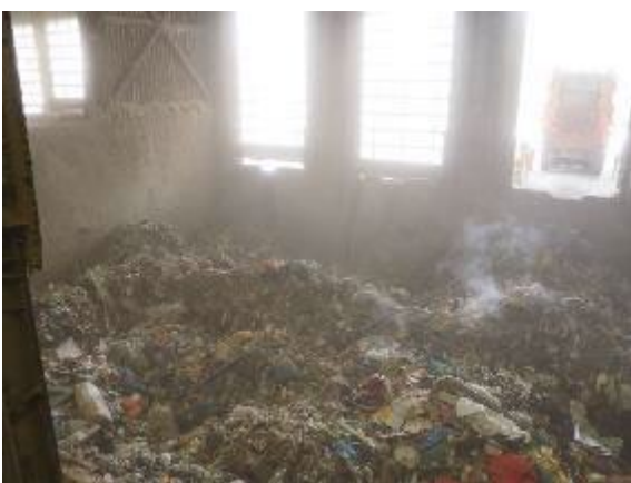
Bild 3: In einem Tiefbunker wird der nasse Abfall aus Holz, Papier, Textilien und Kunststoffen sowie jeder Menge Störstoffe gesammelt.
