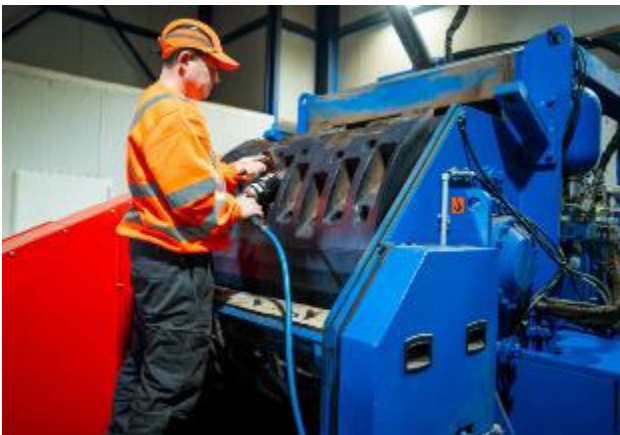
Bild 5: Ein optimales Wartungskonzept ist wichtiger Bestandteil bei der Entwicklung neuer Maschinen – wiederkehrende Vorgänge, wie das Wechseln der Messer, soll somit erleichtert und beschleunigt werden.
