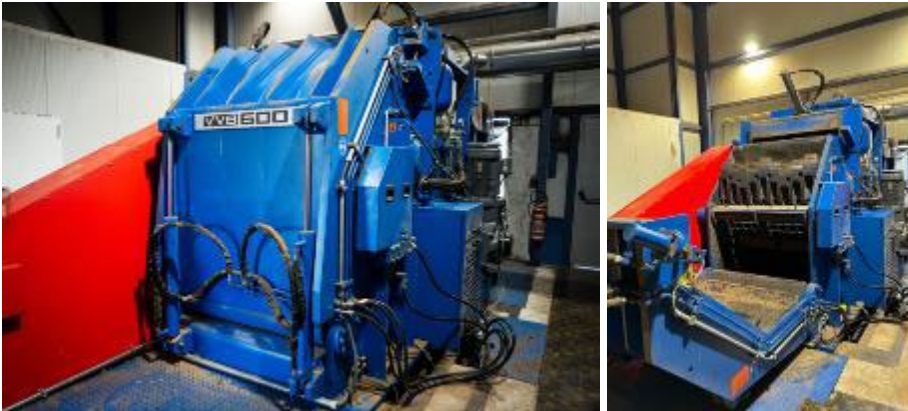
Bild 4 a + b: Der Vorbrecher VVB überzeugt durch eine massive Bauweise – die in die Klappe integrierte Serviceplattform ermöglicht dem Servicepersonal eine ideale Arbeitshöhe.
