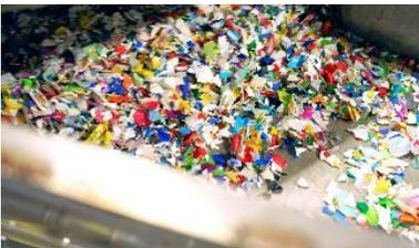
**Bild 2:** Das effiziente Zerkleinern und Reinigen von Altkunststoffen ist ein wichtiger Prozessschritt im chemischen Recycling.
