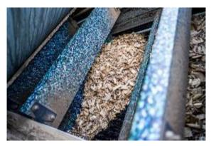
Um geschreddertes Material auf engstem Raum abzutransportieren, lässt sich der Vecoplan Kratzkettenförderer mit einem Schneckenförderer kombinieren.
