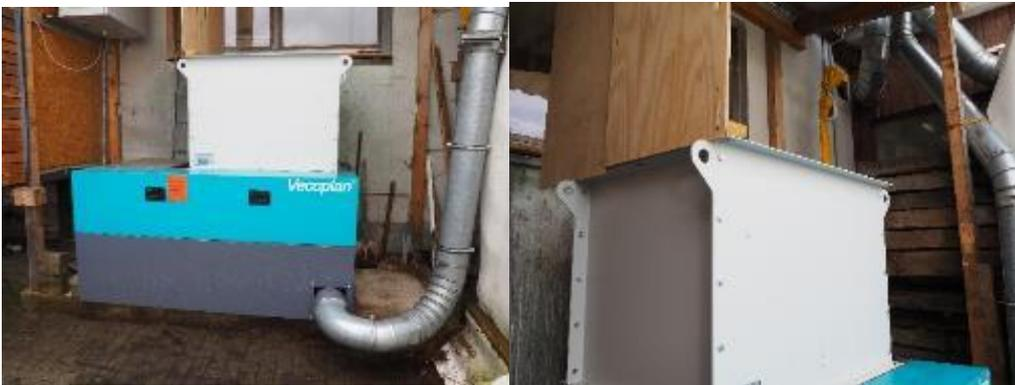
**Bilder 6 a + b:** Um das Holz auf die entsprechende Korngröße zu schreddern, lieferte Vecoplan mit dem VHZ 800 eine langlebige und robuste Zerkleinerungslösung. Über den Einfülltrichter können Stapler Restholz aufgeben.
