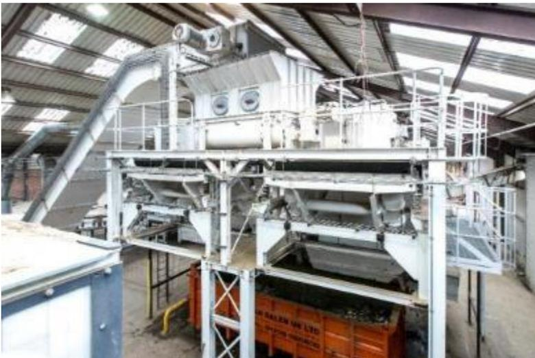
**Bild 4:** Nichteisenmetalle wie Aluminium, Kupfer oder Messing werden später im Prozessablauf durch einen Wirbelstromscheider separiert.
