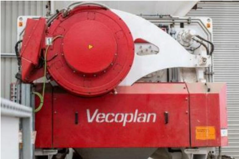
**Bild 3:** Herzstück der Anlage ist der Zweiwellen-Nachzerkleinerer der Baureihe VNZ 2500 von Vecoplan.
