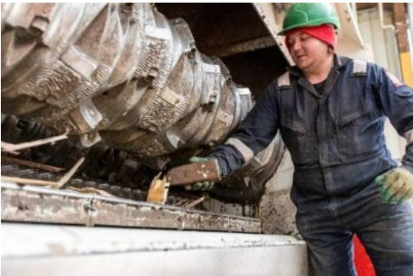
**Bild 1:** Durch die Ausstattung der Vecoplan-Schredder mit dem Flipper werden Beschädigungen durch Störstoffe an den Maschinen vermieden und die Entnahme der Fremdkörper vereinfacht.
