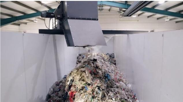
Optimales Materialhandling spielt in der Aufbereitung von Abfällen eine wichtige Rolle. So sorgt das neue Bunkersystem von Vecoplan für einen gleichmäßigen Materialfluss.
