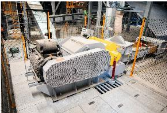
Bild 3: Der Trommelhacker reduziert das Restholz auf eine Hacklänge von maximal 15 Millimetern.
