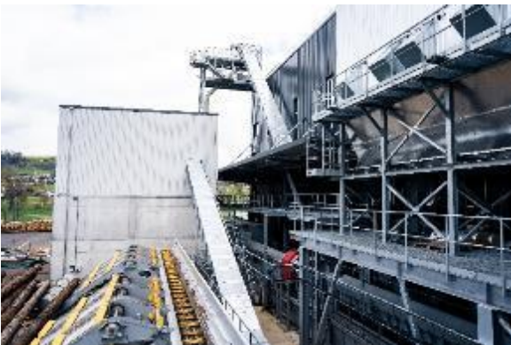
Bild 6: Die in der Box gesammelten Rindenabfälle werden ebenfalls zum Pelletwerk gefördert.
