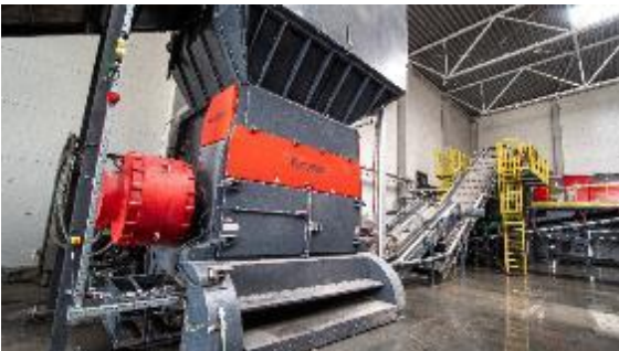
Bild 3: Der VEZ 2500 TV mit einem Torque-Antrieb übernimmt die Vorzerkleinerung. Das Material wird über ein angeschlossenes Förderband zum nächsten Prozessschritt transportiert.
