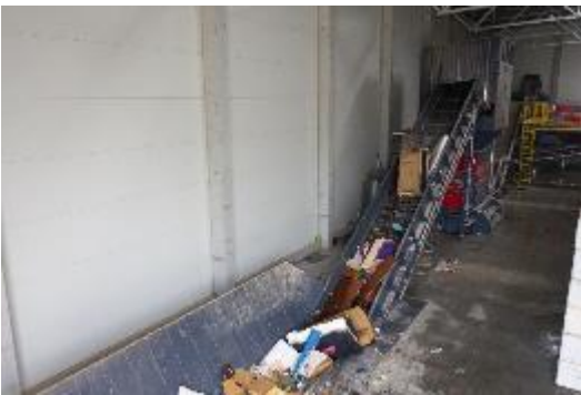
Bild 2: Das Material wird für die Vorzerkleinerung aufgegeben.
