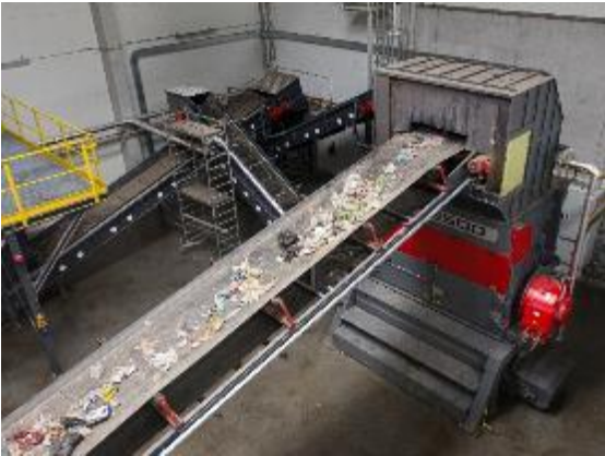
Bild 4: Der VEZ 2500 TT zerkleinert die anspruchsvollen Materialien zu homogenem Output, das als Ersatzbrennstoff eingesetzt wird.
