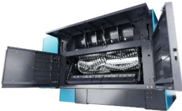
Bild 4: Große Türen und ein hydraulisch absenkbares Sieb ermöglichen eine gute Zugänglichkeit bei Wartungsarbeiten.
