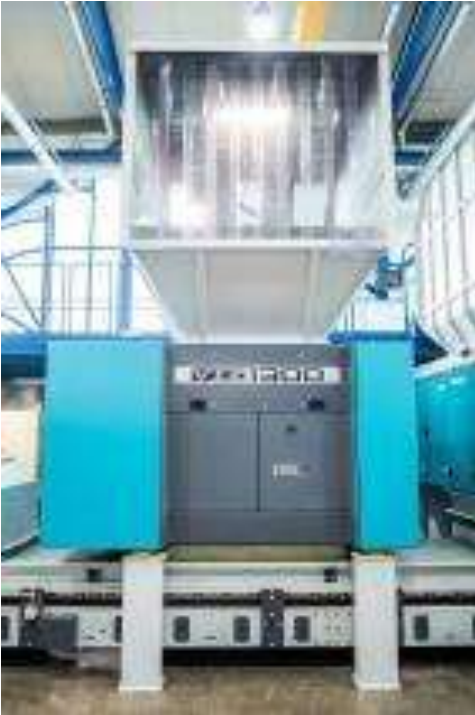
Bild 2: Der neue VIZ von Vecoplan kann vielfältigste Kunststoffmaterialien zuverlässig zerkleinern.
