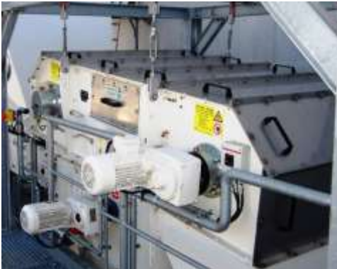
Bild 4: Ein Überbandmagnet zieht eisenhaltige Metalle wie Schrauben oder Nägel aus der Masse.
