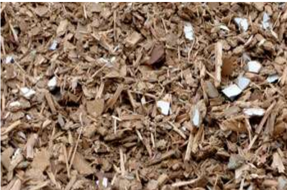
Bild 2: Befeuert wird der Kessel mit Waldhackgut und Altholz. Dazu muss die Biomasse entsprechend aufbereitet werden.
