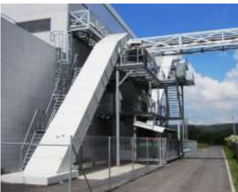
Bild 3: Vecoplan lieferte eine maßgeschneiderte Lager-, Dosier- und Transportlösung. Eine Komponente davon sind Kratzkettenförderer.
