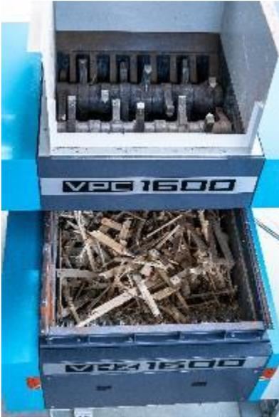
**Bild 3:** ... bevor es die Schneidkronen des VHZ-Rotors zerkleinern.
