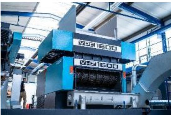
**Bild 1:** Der Vecoplan Pallet Crusher VPC 1600 bildet mit dem VHZ 1600 eine starke Einheit für die Zerkleinerung von großvolumigen Holzteilen.
