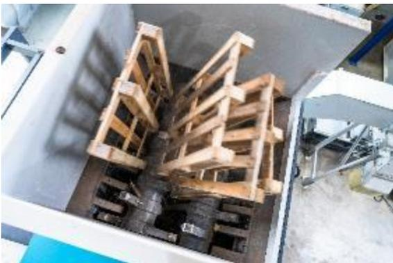
**Bild 2:** Mit dem innovativen Rotor im VPC 1600 wird das Holzmaterial vorgebrochen, ...
